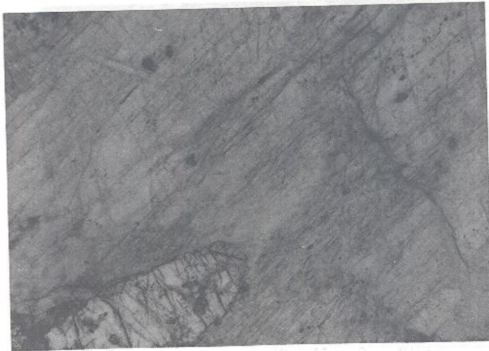
شکل ۱۰- تصویر میکروسکوپی از کانی دیتن نیزه‌ای در ممتنی از سیلیمانیت منشور بدون آنالیزور (x100).
