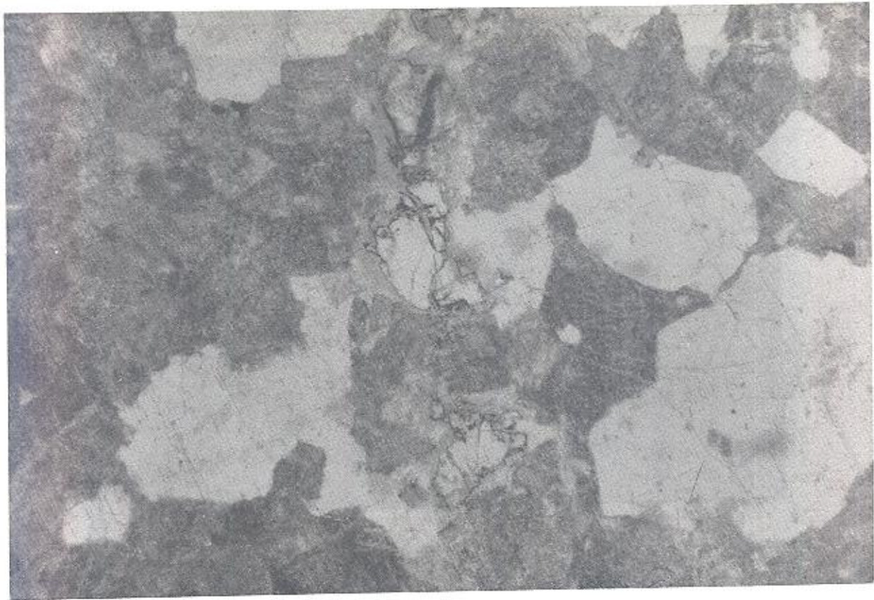
شکل ۷- تصویر میکروسکوپی از کانی آپاتیت در یک نمونه از گرانودیوریت های کلاهقاسی بدون آنالیزور (X ۲۵).
