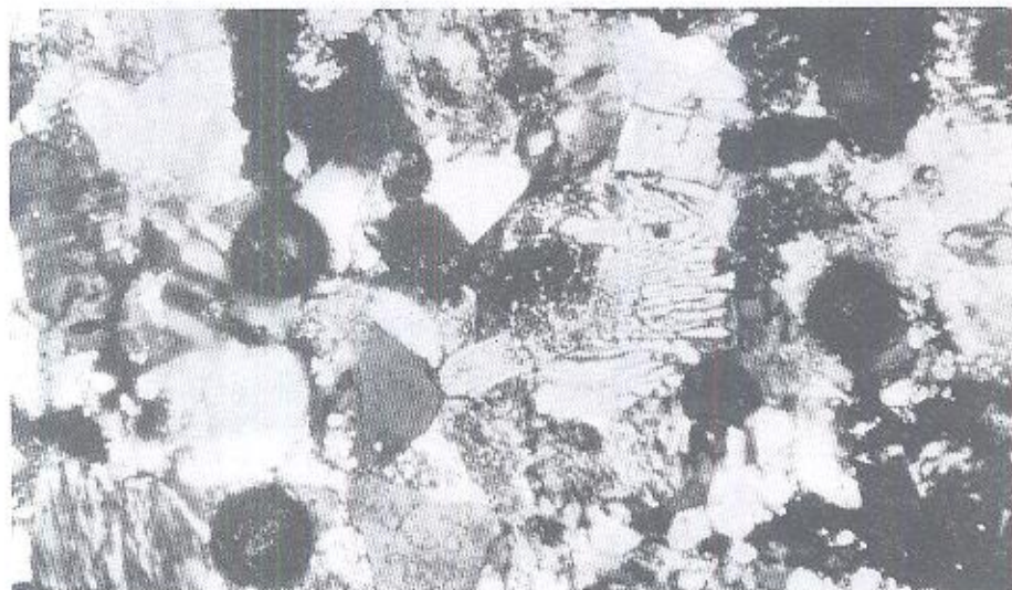
شکل ۹- انحلال سیمان کلسیتی و ایجاد تخلخل ثانوی از نوع extensive حجم تخلخل موجود به علت افزون شدن بخش‌های خورده شده و انحلال حاشیه دانه‌ها به مراتب بیش از تخلخل اولی قبل از تشکیل سیمان است. (بخش‌های سیاه‌رنگ در حاشیه بالا و راست عکس) نورپلاریزه ۸۰×
