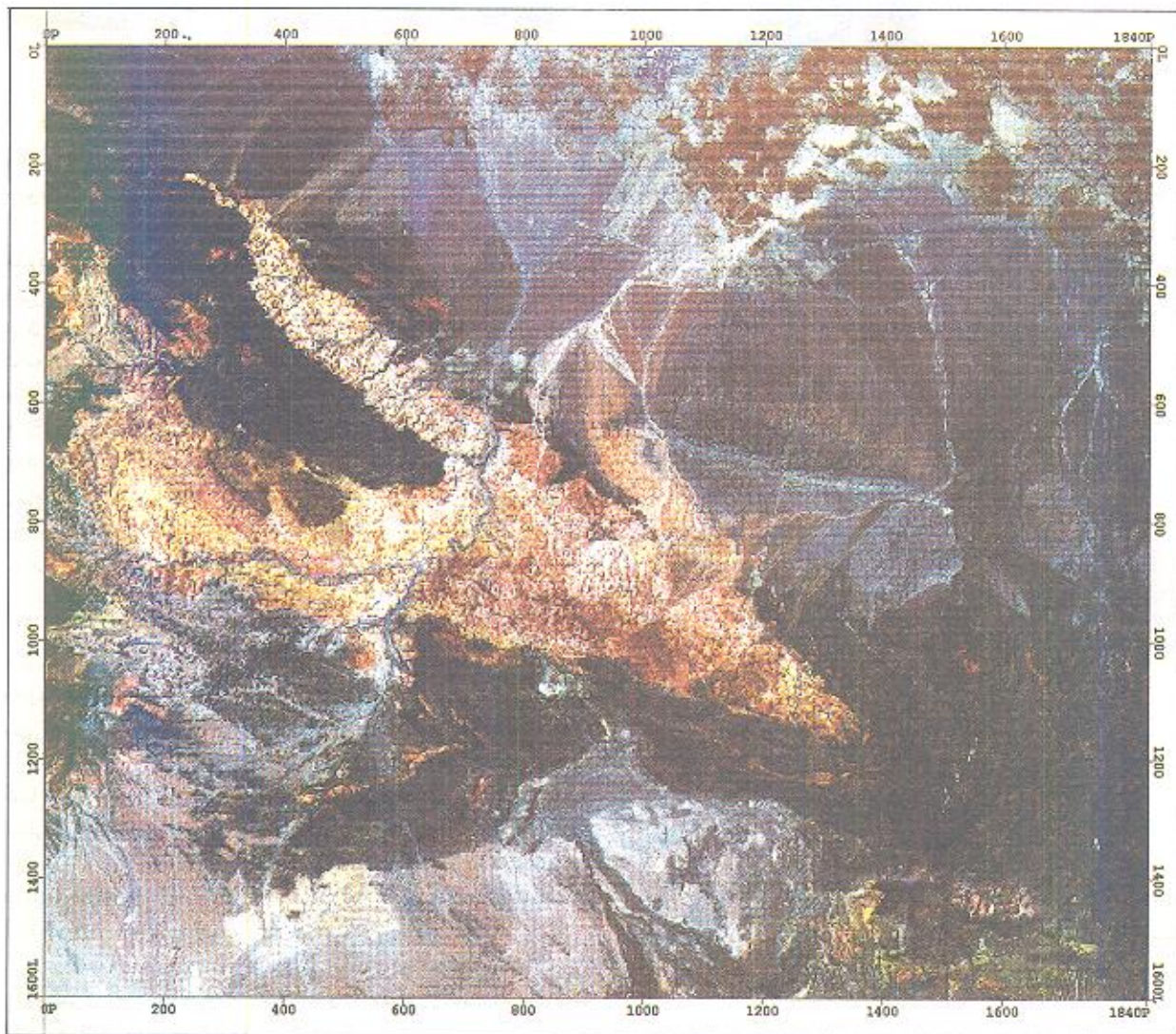
تصویر ۲- تصویر پردازش شده منطقه رفسنجان به روش Equalization
