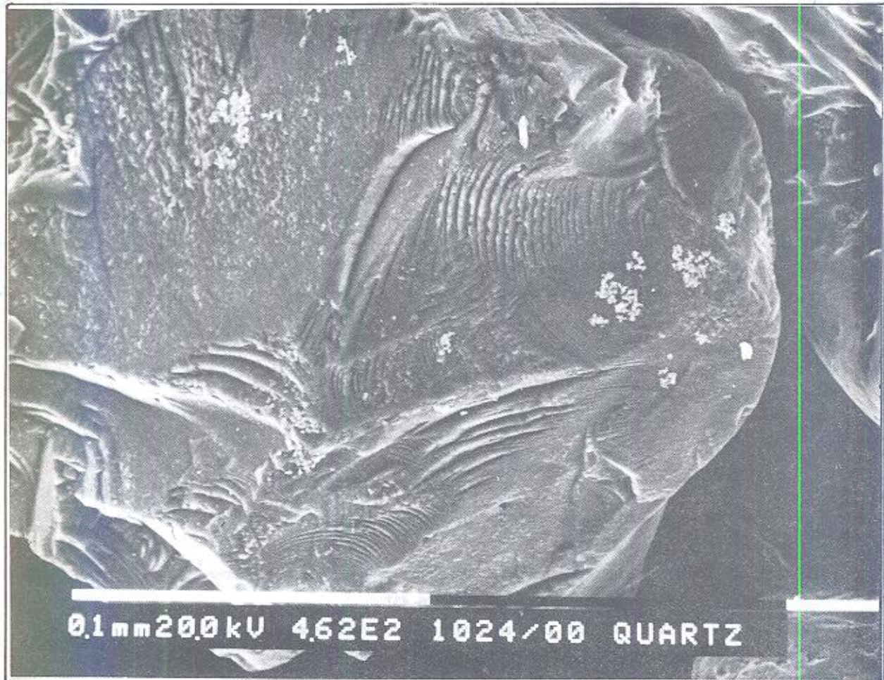
شکل ۶- خطوط کمائی پله مانند و سطح شکست مدفی در گوشه بالای سمت راست این دانه کوارتز دیده می‌شود
