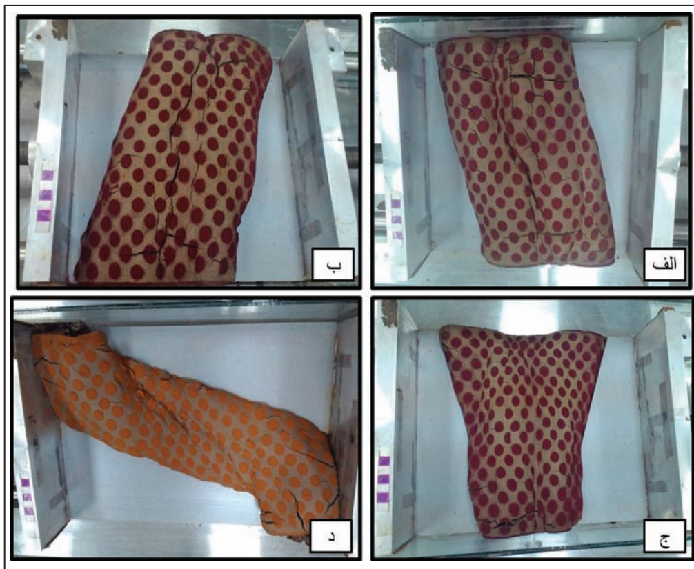
شکل ۶- شبیه سازی تنش های متفاوت در (آزمایش های ۱ تا ۴). الف، ب و ج) شبیه سازی تنش ترا فشارشی با مؤلفه فشارش چیره؛ د) شبیه سازی تنش ترا فشارشی با مؤلفه امتداد لغزی چیره چپ گرد.
