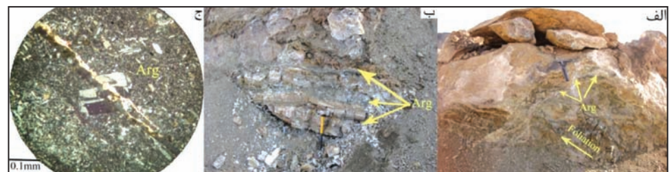
شکل ۶- الف) دگرسانی آرژیلی همروند با برگوارگی دولوستون؛ ب) دگرسانی آرژیلی قطع‌کننده برگوارگی سنگ‌های میزبان و ماده معدنی؛ ج) تصویر میکروسکوپی توده نفوذی که فلدسپارهای آن آرژیلی شده‌اند (نور XPL).
