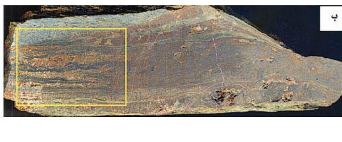
شکل ۱۵- الف) چین خوردگی عدسی‌های آهن منگنزدار همراه با دولومیت در مقیاس رخنمون؛ ب) نمونه دستی از دولومیت دارای آهن منگنزدار غنی از سیلیس، در کانسار چشمه اسی؛ ج) بخش بزرگ شده شکل ب که در آن لامینه‌های اکسید آهن منگنزدار چین خورده‌اند؛ د و ه) چین خوردگی Convolute مانند در لامینه‌های ماده معدنی، هماتیت- مگنتیت (نوارهای تیره) همراه با دولومیت‌ها (dol) و کوارتز (نوارهای روشن) در کانسار چشمه اسی؛ د) نورمقاطع؛ ه) نور ساده.
