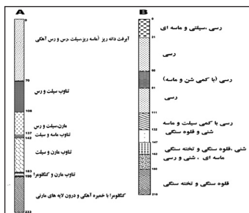
شکل ۲- (A) ستون زمین‌شناسی چاه اکتشافی طاهر آباد (CITRA, 1965) (B) ستون زمین‌شناسی چاه شماره یک شرکت تعاونی چند منظوره دانشگاه باهنر (عباس نژاد، ۱۳۷۷).
