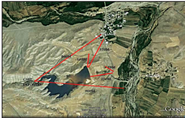
شکل ۲- فاصله سد باطله یک کارخانه از مناطق مسکونی و کشاورزی بر روی تصویر گوگل- ۲۰۰۹.
