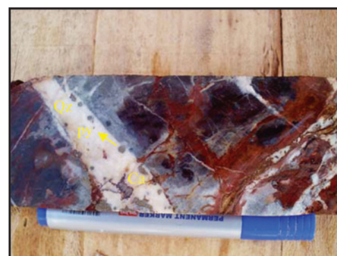
شکل ۹- کانی پیریت در درون رگه‌ای سیلیسی کربناتی که از حاشیه در حال تبدیل به هماتیت و گوئیتیت است.
