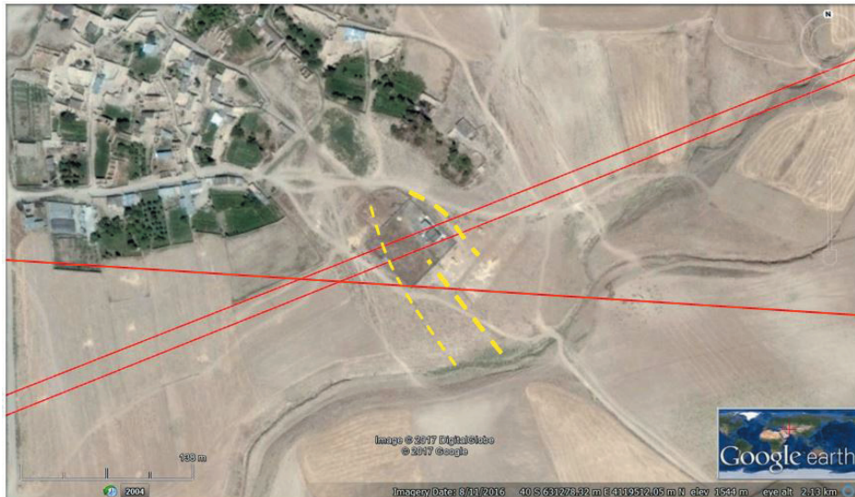
شکل ۶- موقعیت ۳ خطواره در محدوده فنس مورد مطالعه روی تصویر ماهواره‌ای منطقه (خطوط منقطع زرد رنگ). خطوط قرمز رنگ موقعیت و گسترش پروفیل‌های ژئوالکتریک را نشان می‌دهد.
