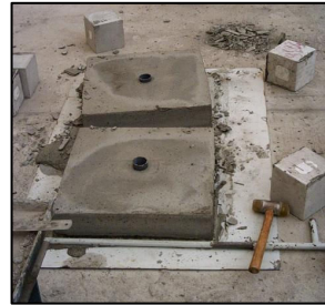
شکل ۴- نمونه ای از بلوکهای مدل سازی شده در آزمایشگاه
