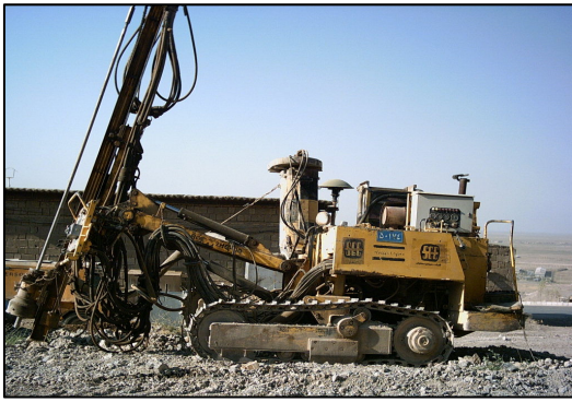
شکل ۵- دستگاه چالزنی مورد استفاده در آزمایشهای زمان سنجی
