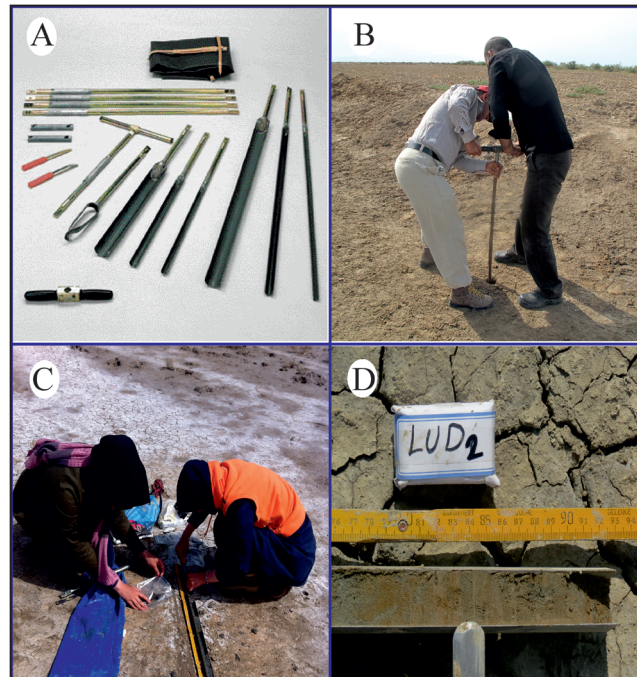
شکل ۲- (A) ادوات مغزه گیری، (B) نحوه مغزه گیری، (C) نمونه برداری و توصیف مغزه های رسوبی، (D) نمونه ای از مغزه های برداشت شده.
