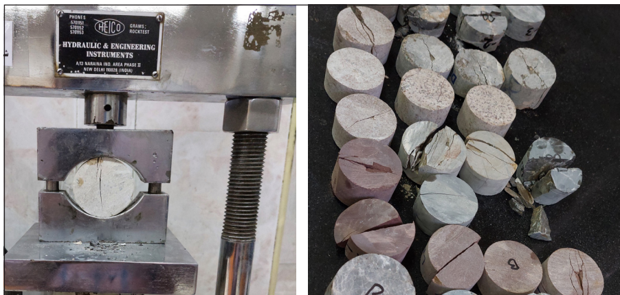
شکل ۱۱- دستگاه آزمون برزیلین و نمونه‌های آزمایش شده.
