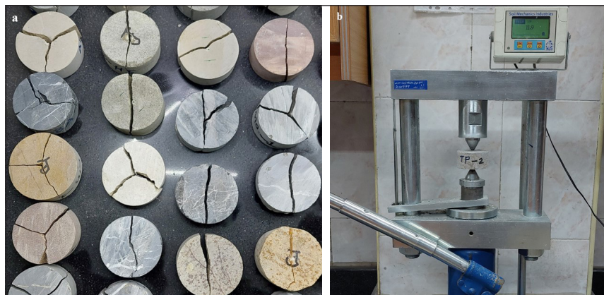
شکل ۱۰- دستگاه آزمون بار نقطه‌ای و نمونه‌های آزمایش شده.
