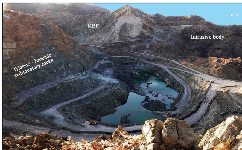
شکل ۷- نمایی از کارگاه استخراج اصلی کانسار آهن سادات، با رخنمونی از توده نفوذی در همبری با سازند کوهبنان. (KBF) در بخش باختری کارگاه استخراج، توده نفوذی با همبری گسلی در کنار نهشته‌های رسوبی تریاس بالا-ژوراسیک زیرین قرار دارد.
