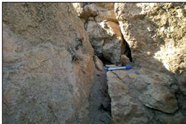
شکل ۶- پرشدگی درزه توسط رس و سیلت.
