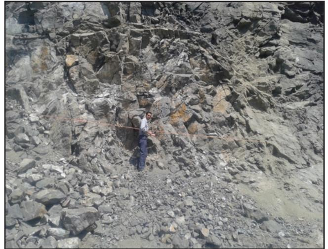
شکل ۵- نمایی از وضعیت ناپیوستگی‌ها و خط برداشت.
