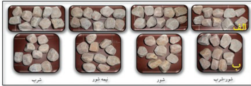
شکل ۵- نمونه ۱: الف) پیش از آزمون دوام؛ ب) پس از گذشت ۳۰۰ روز اشباع نمونه‌ها در آب در چهار حالت مختلف.
