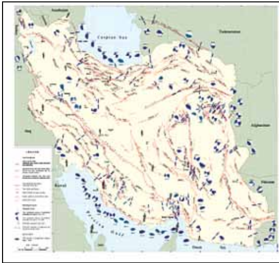
شکل ۲- آرایش گسل‌های فعال در ایران و سازوکار کانونی برخی از زمین‌لرزه‌های مربوط (حسامی، ۱۳۸۲)
