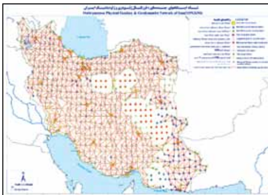
شکل ۱۰- شبکه ایستگاه‌های سنگی چند منظوره فیزیکی ژئودزی و ژئودینامیک ایران (Hatam et al., 2008)
