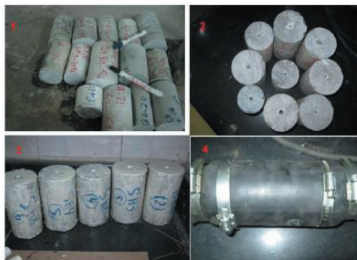
شکل ۹- مراحل مختلف آماده‌سازی و انجام آزمایش انحلال‌پذیری.
