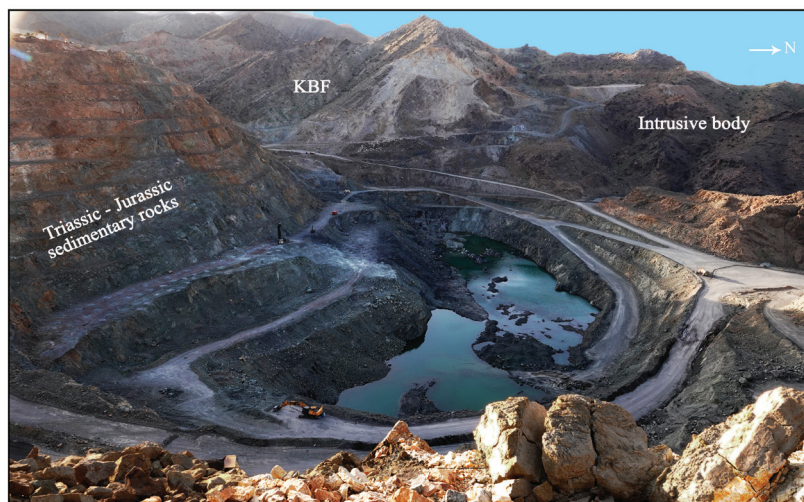
شکل ۷- نمایی از کارگاه استخراج اصلی کانسار آهن سادات، با رخنمونی از توده نفوذی در همبری با سازند کوهبنان. (KBF) در بخش باختری کارگاه استخراج، توده نفوذی با همبری گسلی در کنار نهشته‌های رسوبی تریاس بالا-ژوراسیک زیرین قرار دارد.
