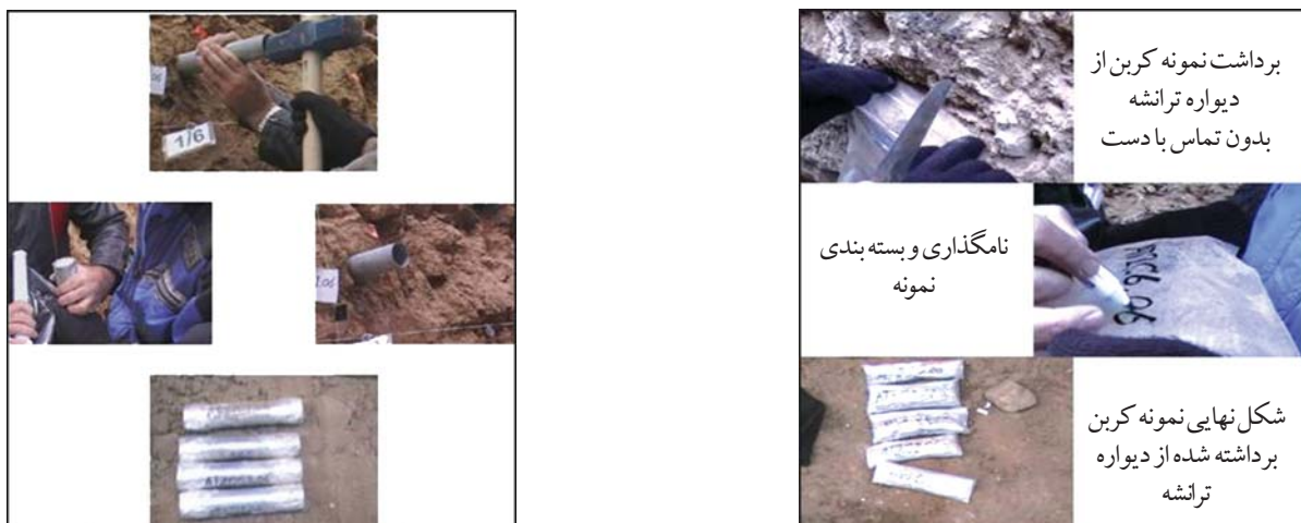
شکل ۹- روش برداشت نمونه برای تعیین سن به روش کربن ۱۴ از دیواره ترانسه
