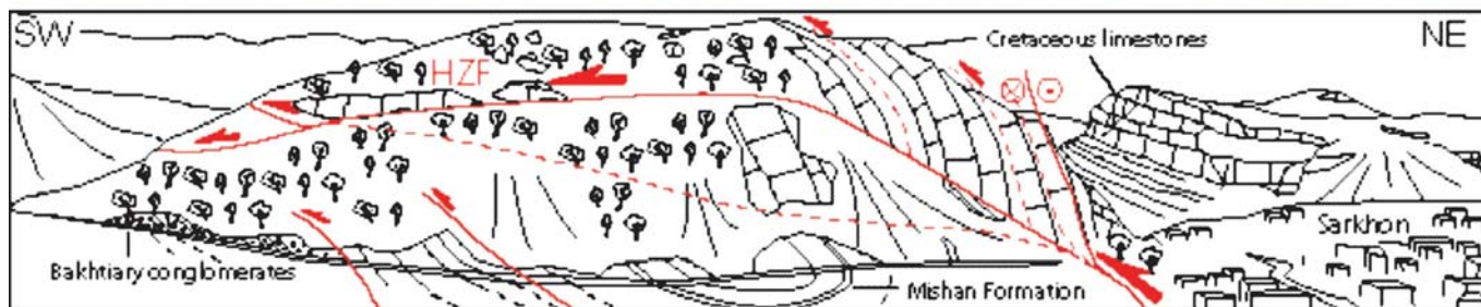
شکل ۸- مقطعی از گسل بازفت که در آن سازندهای مربوط به کرتاسه روی سازند میشان و کنگلومرای بختیاری رانده شده‌اند. سازند میشان در حرکت توده سنگ‌های متعلق به کرتاسه به عنوان یک سطح جدایش عمل می‌کند و گسلش در بخش مرکزی خود شامل حرکات امتداد لغز با مؤلفه راست گرد است.
