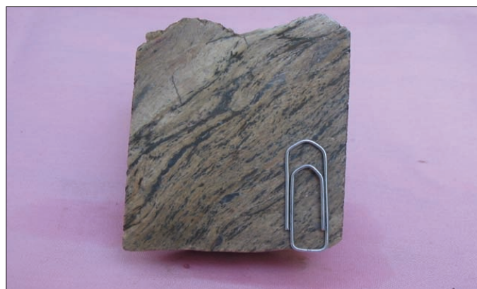
تصویر ۹- بافت ریز لایه در نمونه‌ای از افق کان‌دار III در این تصویر بخشهای روشن، عدسیهای متاچرتی حاوی زیر لایه‌های شیلیت دار هستند. ریز لایه‌های شیلیت به تبع از سنگ درونگیر چین خورده‌اند.
