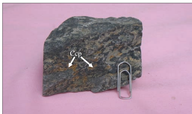
تصویر ۱۴- بافت نیمه توده‌ای کلکوپیریت (Ccp) در افق کان‌دار V در همبندی بالایی آهک‌های دگرگون شده و توفهای فلسیک. بخشهای زرد رنگ، کلکوپیریت است.
