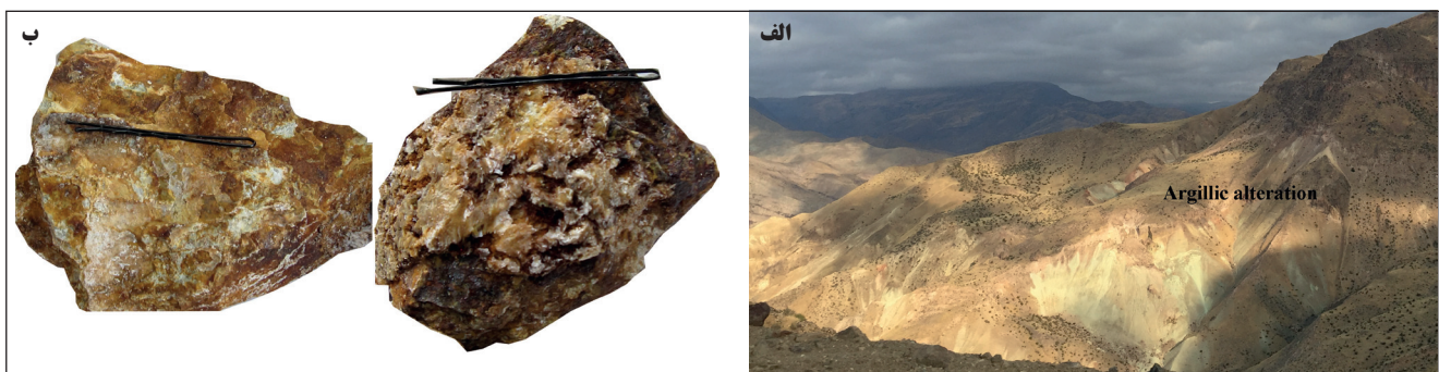
شکل ۴-الف) نمایی از دگرسانی آرژلیک، ب) تصویر نمونه دستی کوارتز حفره‌ای در پهنه دگرسانی آرژلیک.
