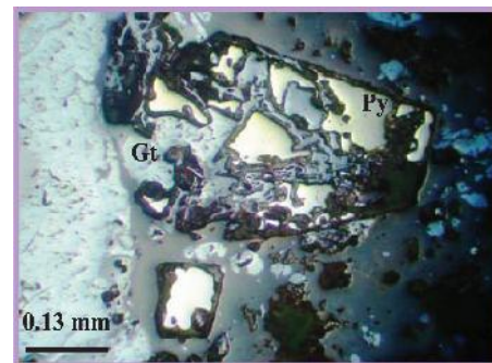
شکل ۱۲- پیریت شکل‌دار و جانشینی کانی گوتیت در شکستگی‌های داخلی آن، (10X).
